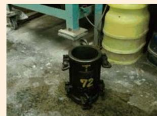
2分割式の鋼製型枠
