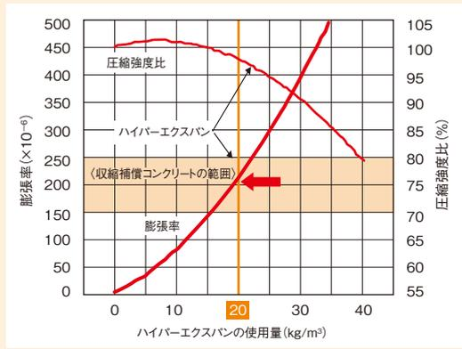
低熱ポルトランドセメントでのハイパーエクспанと膨張率の関係(例)
