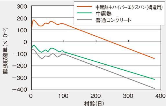
実構造物の計測 (中庸熱+膨張材)
