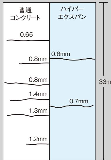
ハイパーエクспанを使用することにより、適切な膨張が導入されるとともに、長年に渡り、ひび割れを大幅に低減することができています。
