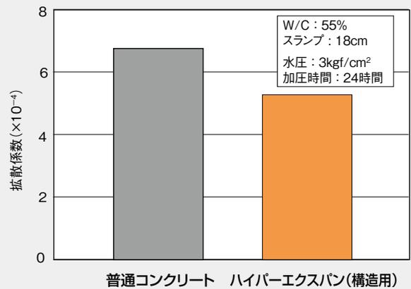
JASS5鉄筋コンクリート工事「水密コンクリート」では膨張材を用いてコンクリートの収縮ひび割れを防ぐことは、コンクリート構造物の水密性の向上に効果があると記載されています。
