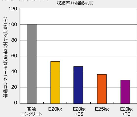
E: ハイパーエクспан (構造用) CS: 塗布型収縮低減剤 (クラックセイバー) TG: 収縮低減剤 (テトラガード)
