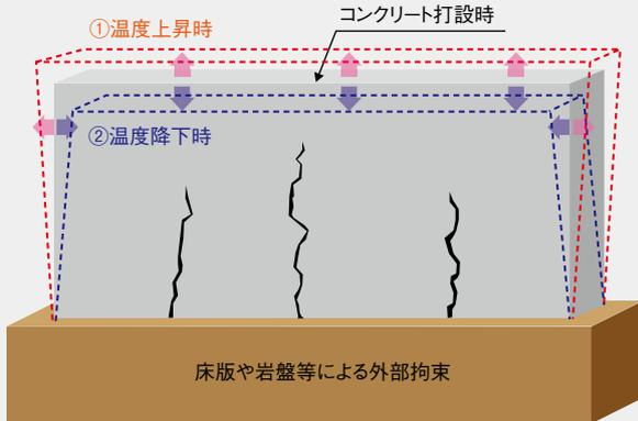
普通コンクリートは、温度上昇時から下降時における体積収縮を床版等により拘束されることにより、引張り応力が発生します。
